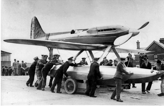
Le Supermarine S6B du Trophée Schneider, moteur Rolls-Royce type R de 2300 cv. Il dérive du 6, qui avait atteint 575 km/h, en 1929 avec un Rolls-Royce du type R, qui ne développait alors « que » 1500 cv
